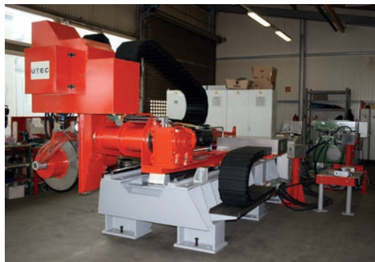
Sistema de sellado de rieles
